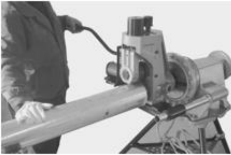
Рис.6 Нажим на трубу, когда силовой привод работает в режиме FOR
